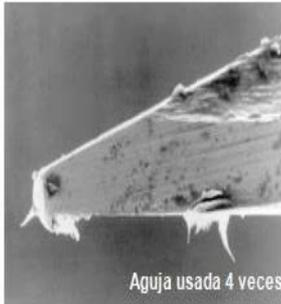
Fotografías al Microscopio Electrónico de Barrido (aumento x 4.000) realizadas por la Universidad de Grenoble (Francia)
